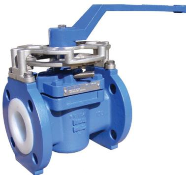
**EZ-SEAL®** : système permettant un réglage uniforme et en simultané de la compression sur 360° du presse-étoupe, éliminant ainsi les charges latérales. Une indication visuelle permet d'observer facilement et précisément la durée de vie restante du presse-étoupe.
